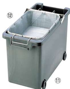
⑪強化耐熱プラスチック フライヤー用 油缶(カゴ付) ページコード 商品コード 価格 5-0906-1101 5622500 ¥31,200 外寸:275×550×H335 容量:30ℓ 耐熱温度:265℃ 材質:本体・キャスター/ナイロン66GS 把手部/ステンレス製
