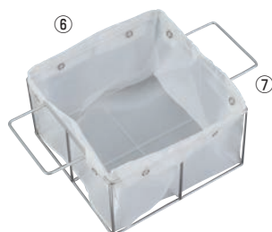
⑥EBM オイルフィルター 一斗缶用 ページコード 商品コード 価格 5-0906-0601 0390610 ¥8,400 外寸:200×200×H120 アミ目:120メッシュ 耐熱温度:200℃
