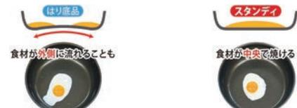
IH対応フライパンは底にステンレス板を貼っていますが、熱により反りやすいのが難点です。スタンディはステンレスを使用せず鉄粉とアルミニウム粉を吹き付けているので変形しにくくなっています。
