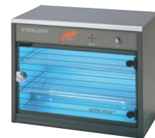
⑲ 殺菌線消毒保管庫 NB-5 ¥65,000 8395700 ¥65,000 外寸:430×250×H330 電源:単相100V 10W紫外線球×2
